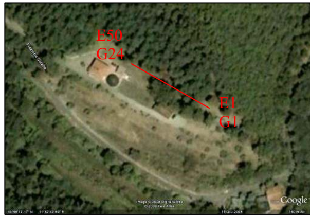
Fig. 3 – Ubicazione del lineamento 2, sismico e geoelettrico, eseguito parallelamente rispetto alle curve di livello (E= elettrodo; G= geofono).
