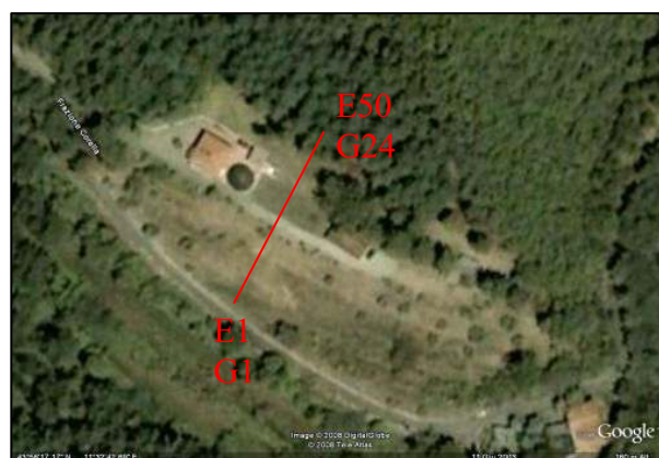
Fig. 2 - Ubicazione del lineamento 1, sismico e geoelettrico, eseguito perpendicolarmente rispetto alle curve di livello (E= elettrodo; G= geofono).
