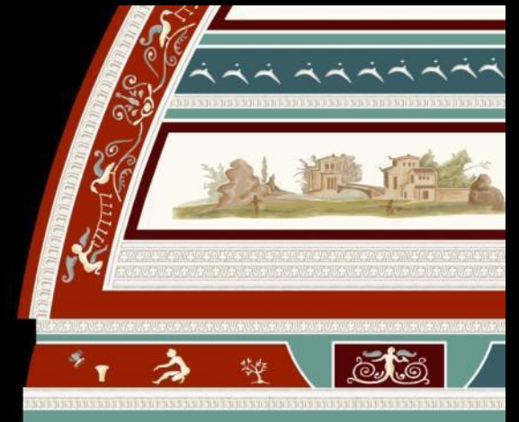
Dettaglio delle diverse modanature in stucco a foglie d'acqua e a kyma lesbio nella ricostruzione attuale
